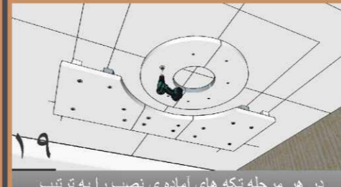
در هر مرحله تکه های آماده ی نصب را به ترتیب به زیر نقاط علامت گذاری شده برده و پس از چسباندن تا استحکام اولیه چسب بوسیله اتصالات مکانیکی توسط پیچ تکه ها را به سقف و به یکدیگر متصل نمایید.
