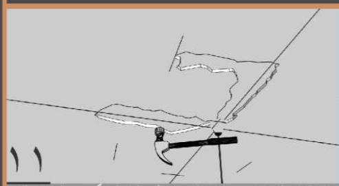
توجه داشته باشید در صورت نیاز به منظور انشعاب گیری برای سیم کشی برق هالوژن ها و نوار ال ای دی پس از بررسی های اولیه شروع به تخریب نقاط جهت انشعاب گیری سیم های برق نمایید. پس از تخریب، با رعایت استاندارد های برق کاری و کمک از یک تکنسین برق شروع به سیم کشی برای انشعابات لازم نموده.
