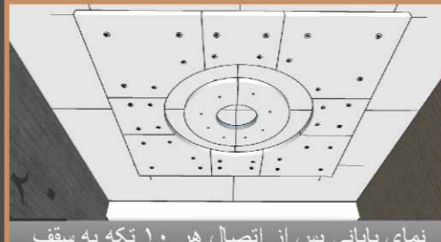
نمای پایانی پس از اتصال هر ۱۰ تکه به سقف به منظور گیرایی نهایی چسب آرک ۲۴ ساعت در دمای مناسب ۱۸ درجه به بالا نگه داشته و سپس اقدام به مراحل پرداخت کاری نمایید.
