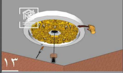
۱۳ پس از خشک شدن بتونه ها اقدام به سمیاده کردن محل بتونه شده نمایید و در صورت نیاز بوسیله یک قلم موی نازک رنگی اقدام به لکه گیری نقاط بتونه شده نمایید.
