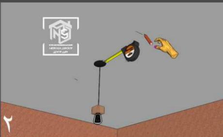
۲ در این مرحله با توجه به قطر محصول مورد نظر اقدام به اندازه گیری تقریبی نمایید تا در صورت داشتن ایراداتی در سقف آن را برطرف و زیرکاز را آماده نصب محصول نمایید. توجه داشته باشید محل نصب می بایست خشک و عری از هرگونه گرد و غبار و پارطوبت ناشی از آب یا روغن باشد.
