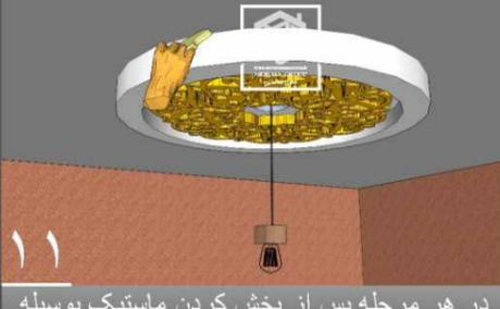
۱۱ در هر مرحله پس از پخش کردن ماستیک بوسیله انگشت اشاره ماستیک را بکنواخت به دور شکاف هدایت کنید و در انتها با یک ابر خیس اضافات را پاک نمایید.
