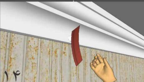
پس از خشک شدن بتونه رد بتونه ها را بوسیله یک سمباده نرم تا دستیابی به یک سطح صاف و مناسب سمباده نمایید توجه داشته باشید در برخی موارد پروسه بتونه کاری را در چندین نوبت تا دستیابی به یک سطح قابل قبول ادامه دهید.
