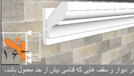
در دیوار و سقف هایی که قناسی بیش از حد معمول باشد، همچنین دیوار های بتونی و از جنس سرامیک به منظور دستیابی به یک نتیجه ی بهتر از نوار زیر سازی استفاده نمایید.
