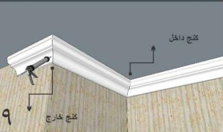
در ادامه با بررسی کنج های موجود و اندازه گیری فواصل فی مابین اقدام به ترسیم پلن برش ابزار ها نمایید.
