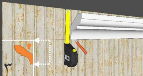
ابزار را به صورت پیش فرض به دیوار چسبانده و با بررسی محیط و اندازه گیری ابعاد ابزار و تعیین فاصله مناسب از سقف اقدام به ترسیم پلن کاری و علامت گذاری بر روی دیوار نمایید.
