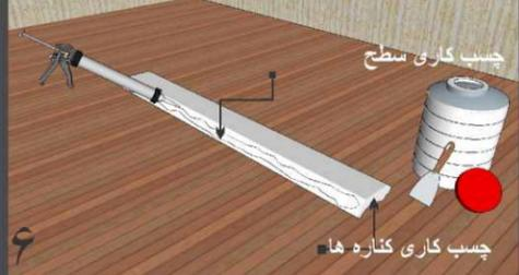
با پخش کردن چسب به صورت یکنواخت با روش تیپویی یا کار دک، آماده برای نصب ابزار ها شوید.
