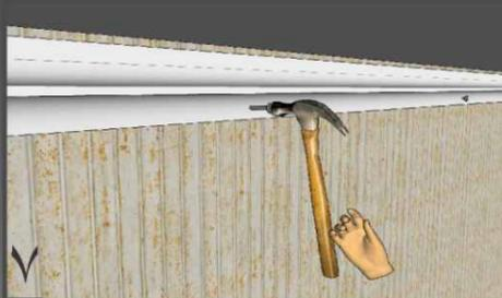
پس از اتصال ابزار بر روی خط راهنما تاگیری اولیه چسب اقدام به اتصال مکانیکی توسط میخ نمایید.
