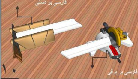
در این مرحله برای برش و نصب ابزار گلوبی از یک فارسی بر استفاده نمایید. به منظور سهولت در پروسه نصب برگه راهنمای نصب بوسیله فارسی بر را مطالعه فرمایید.
